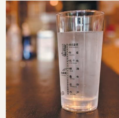
パッド印刷…ボールなど球体素材、器やコップなどの曲面素材、表面に凹凸のある素材などの印刷が得意。
